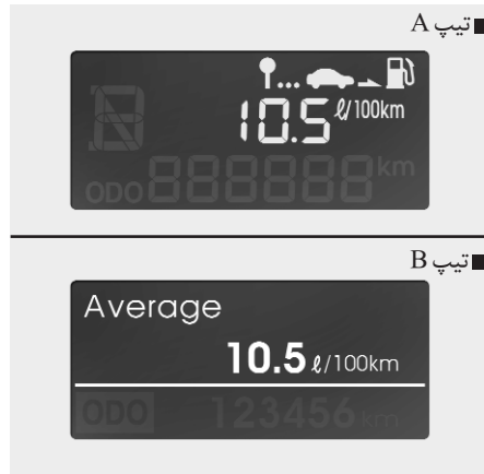
تیب A تیب B متوسط مصرف سوخت (لیتر در هر ۱۰۰ کیلومتر یا MPG)
